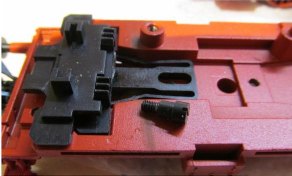
Für die notwendigen Fräsarbeiten nehme ich auch die hintere Kupplungsmechanik heraus, damit nichts beschädigt wird
